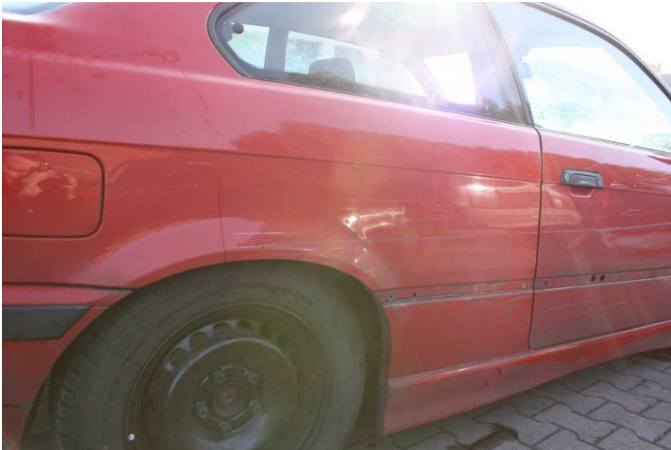
Bild 13: Beschädigungen am hinteren rechten Seitenteil
