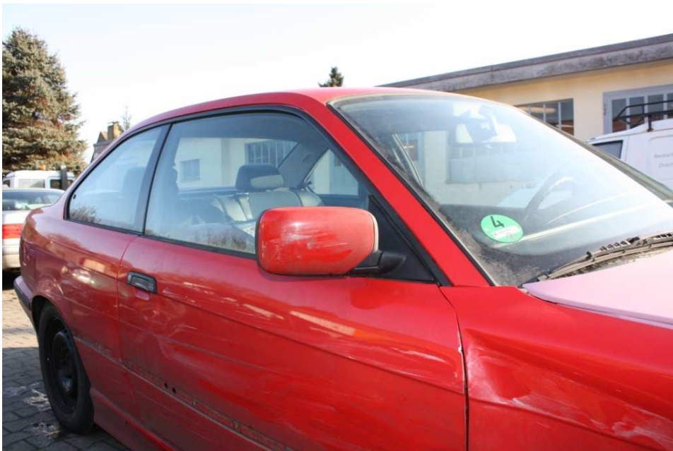
Bild 10: Lack- und Materialschäden am rechten Außenspiegel
