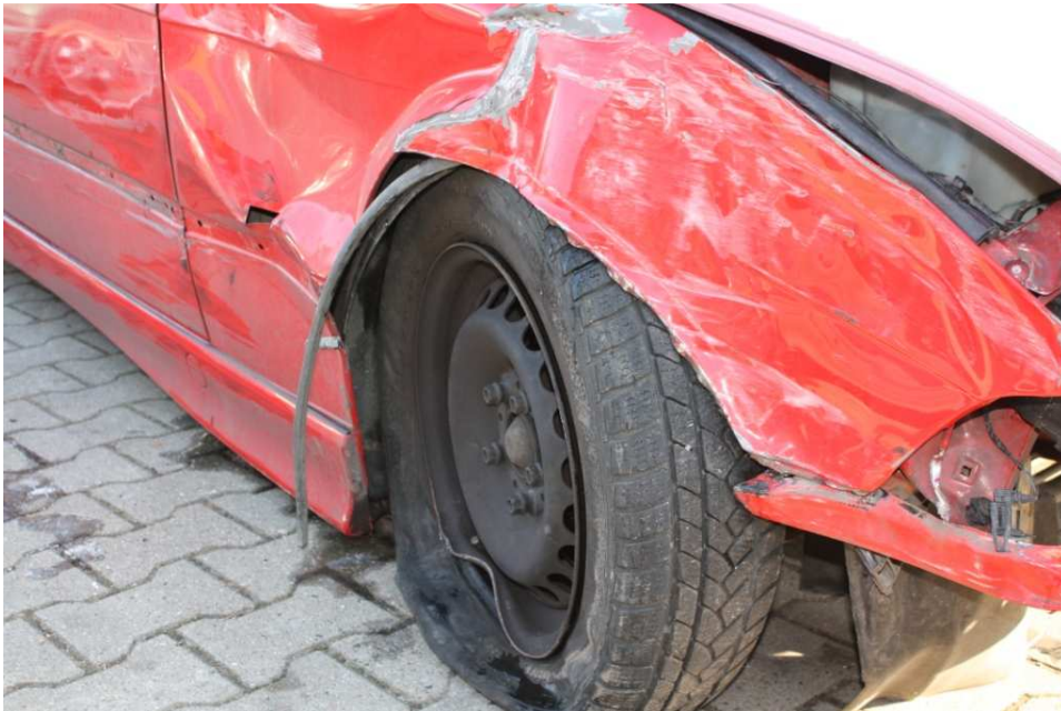
Bild 7: Beschädigungen am Kotflügel, Reifen und der Aufhängung
