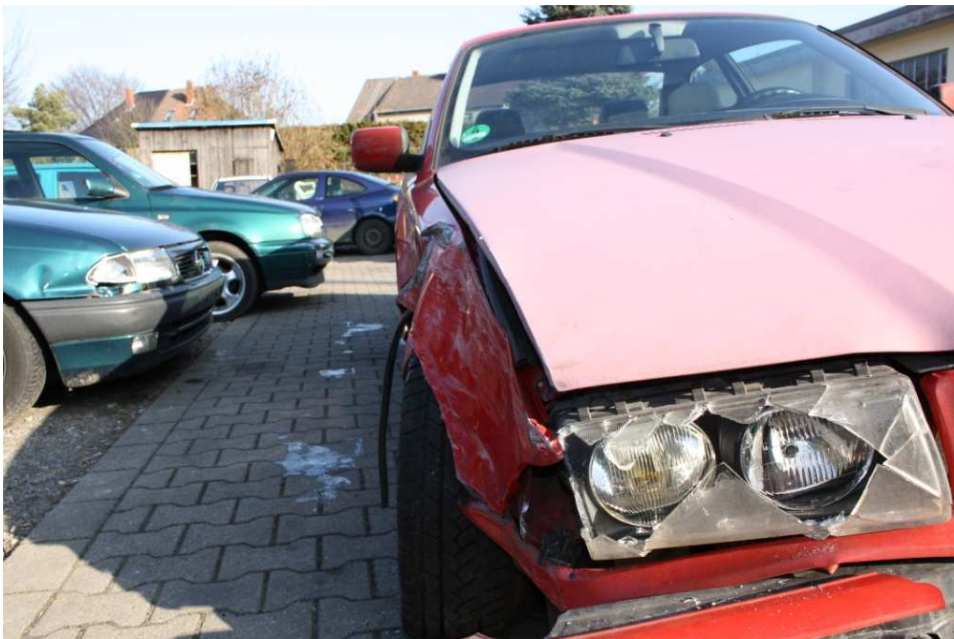
Bild 4: Ansicht der Anstoßstelle quer zur Fahrzeuglängsachse
