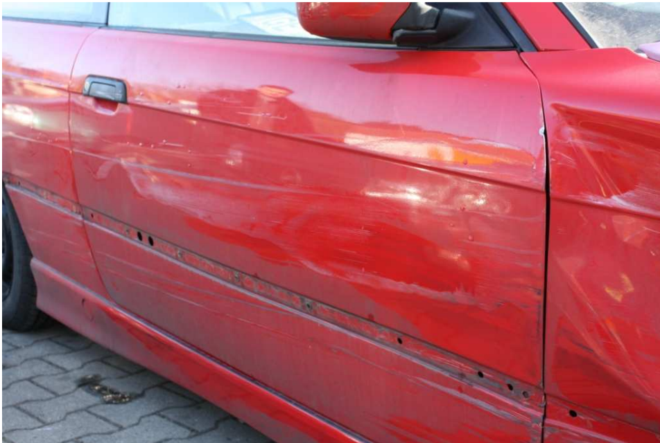
Bild 9: Lack- und Karoserieschäden an der Beifahrertür
