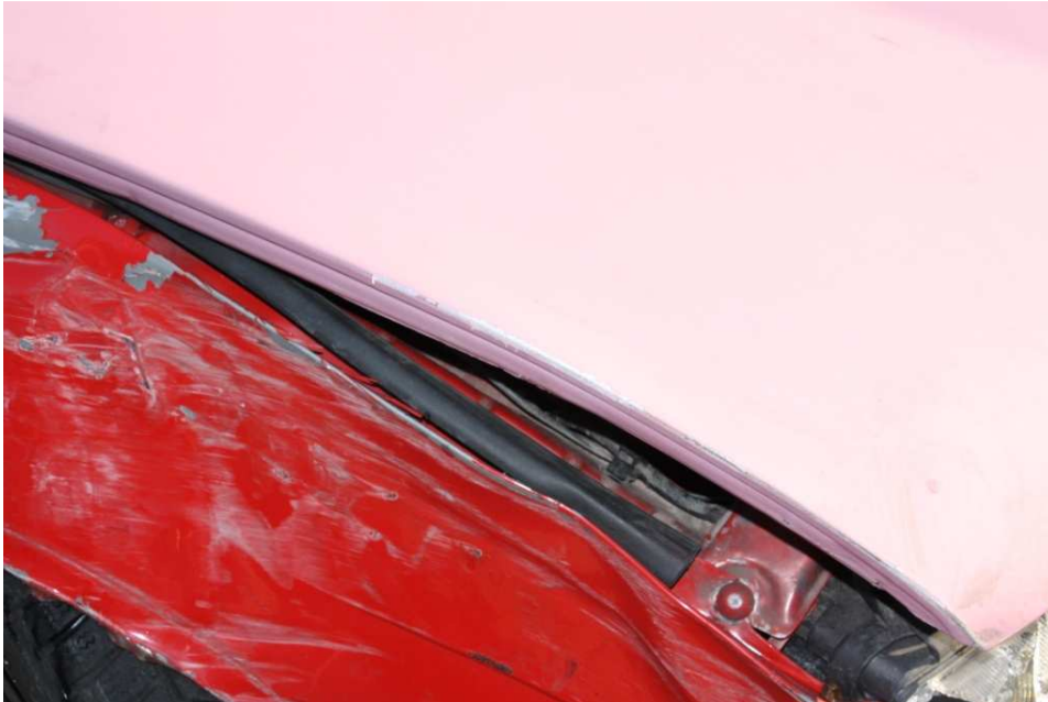
Bild 11: Beschädigungen (Lack- und Karosserie) an der Motorhaube
