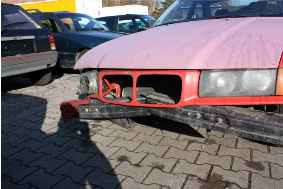
Bild 3: Beschädigungen an der Fahrzeugfront
